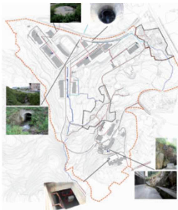
Rede artificial do sistema auga nos campus de Elviña e A Zapateira da UDC.
